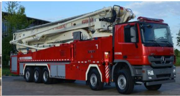
公司研制的 62 米举高喷射消防车，具有世界最大的 56 米比价跨度，较常规高喷消防车超出 1 倍以上，同时最小跨距仅 4 米，其对应
